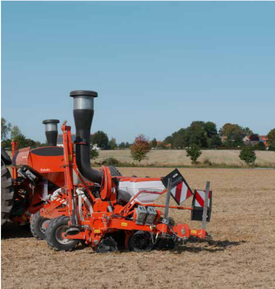
Hohe Manövrierfähigkeit beim Transport durch das um 90° drehbare Cross-shaft der Deichsel.
