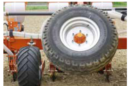
Während der Aussaat werden die Räder, die für den Straßen transport benötigt werden, ausgehoben.
