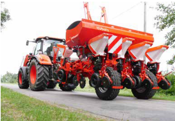
PP1601TF - Sehr kompakt in Transportposition. Ausgelegt für eine Transportgeschwindigkeit von bis zu 40 km/h mit EU Typenzulassung.
