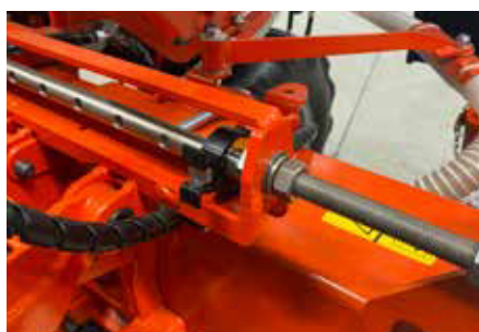
Reihenweiten schnell und einfach einstellen.
