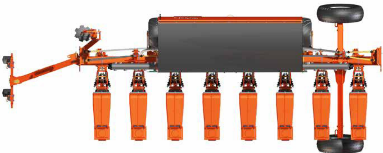
Draufsicht in Transportstellung. Transportbreite < 3 m für sicheren Straßentransport.
