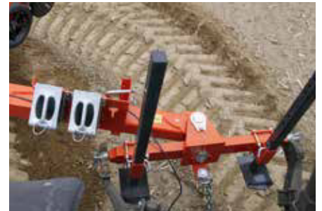
Hohe Manövrierfähigkeit beim Transport durch das um 90° drehbare Cross-shaft der Deichsel.
