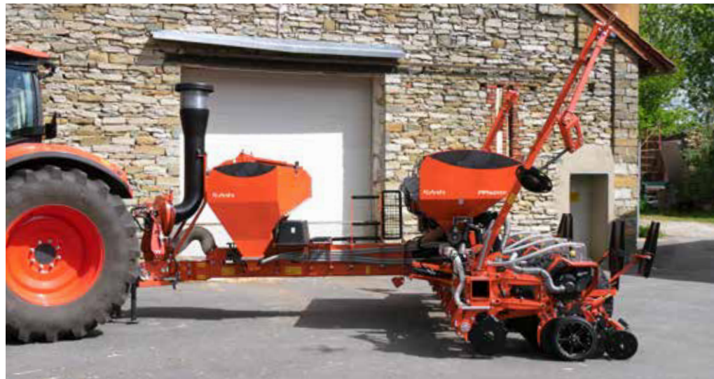
PP1601TF mit SX Säreihen und zentralem Saatguttank von 870 l.
