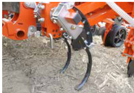
Mit Blattfedern bestückte Spurlockerer sorgen für eine Lockerung der Verdichtung, indem sie den Spuren der Traktorräder folgen.
