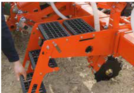
Einfacher Zugang zum Düngerbehälter dank der Beladestufe und der Plattform.
